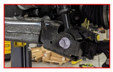
Install the factory sway bar bolt.
